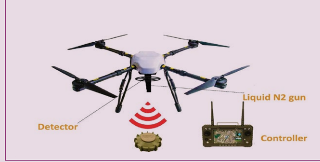
الشكل (1): طريقة تحديد الألغام وتأمينها باستخدام النيتروجين المسال.
